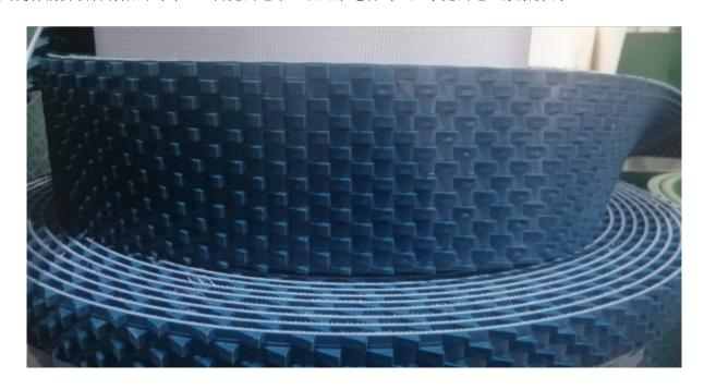
在桥梁施工或加固工程时要使新老混凝土融合的更加结实需要扩大接触面积使用到免凿毛止浆带,使平整的毛面变成麻面,这样新老水泥就会融合的更加结实。
